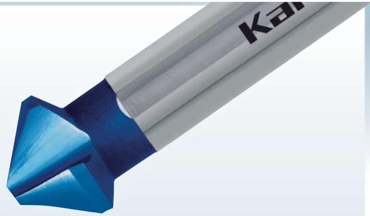
Bei Karnasch Hochleistungs-Kegelsenkern werden die Spannuten prinzipiell CBN-geschliffen. **Dies garantiert:** Hervorragende Spanabfuhr / ratterfreies Arbeiten / riefenfreie Oberfläche / beste Zentriereigenschaften.
