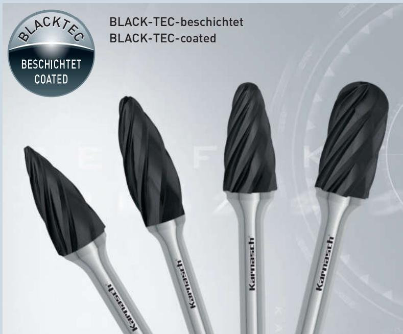
Karnasch BLACK-TEC-Beschichtung wurde speziell für NE-Metalle entwickelt (Verzahnung HP-7) hervorragende Reib- und Gleiteigenschaften verringern die Bildung von Aufbauschneiden.
